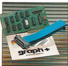
Graph +: Interface paralela para impressora com funções gráficas e comandos próprios para as impressoras nacionais.
